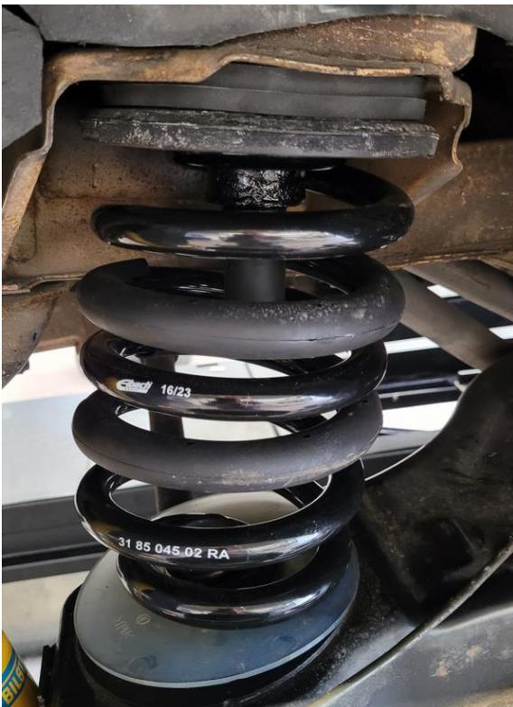
Abschließend wird die mitgelieferte Höherlegungsfeder gemäß Werkstatthandbuch montiert.
